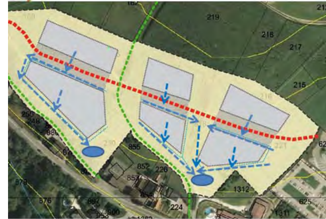
Principe d'évacuation et rétention des eaux pluviales
